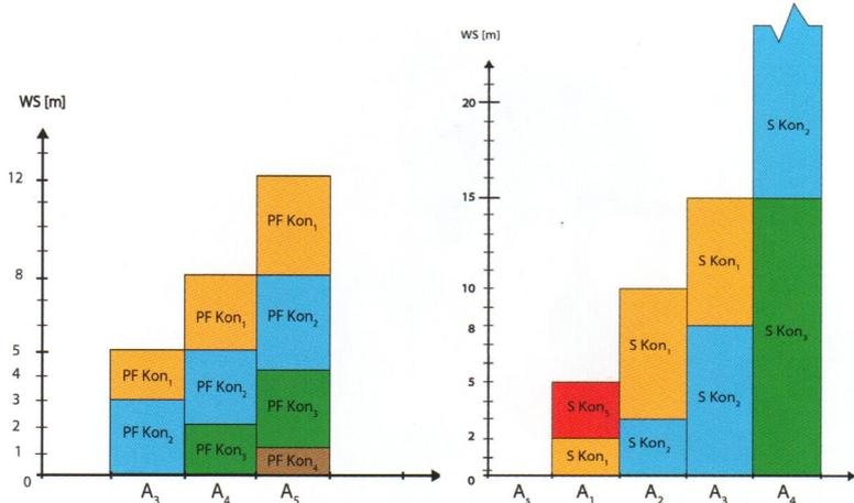
Bild 2: Die durchführbaren Konstruktionsklassen in Abhängigkeit der Anforderungsklassen im Vergleich zwischen Schlitzwänden und Bohrpfehlwänden.
